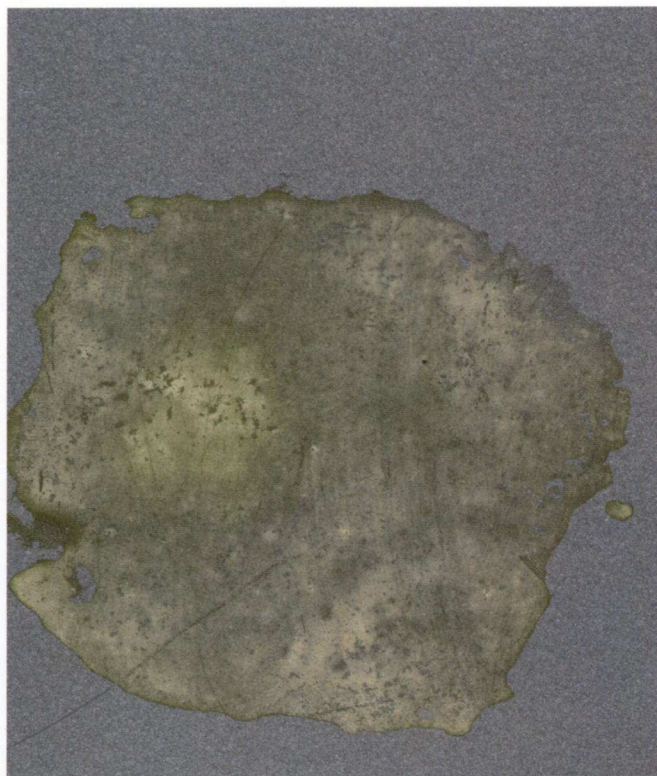
Пример порошкового покрытия металлик; после 24-часового контакта с известковой штукатуркой. Изменение поверхности пигментов, дающих спецэффекты – коррозия алюминиевых частиц. Остатки известкового раствора.
