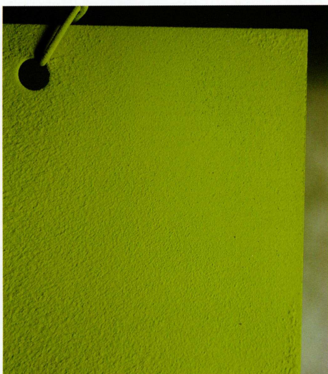
Пример сдувания порошка с краевых участков.
