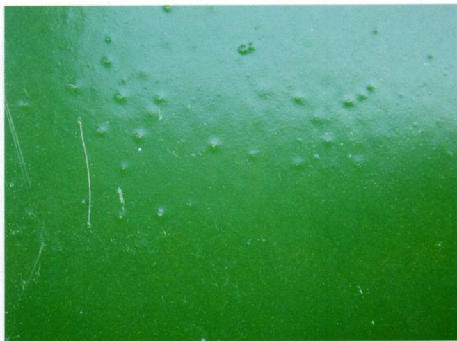
Пример образования вздутий на сплаве с магнием после проведения коррозионного испытания.
