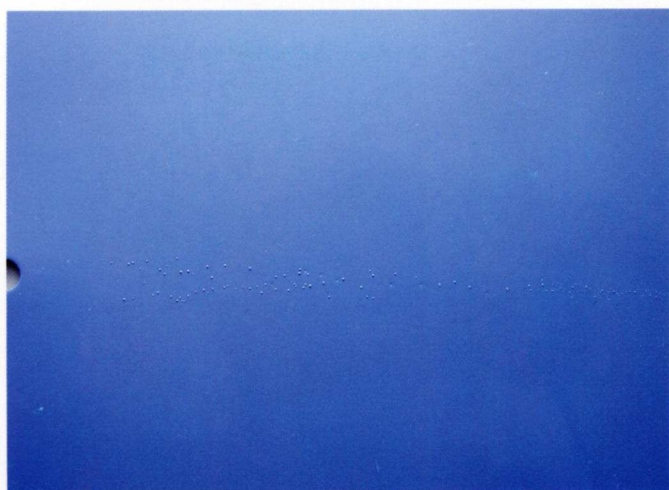
Линейный характер образования вздутий, начиная от точки подвески – недостаточная промывка. Образование следов от потеков в месте сверления отверстия или подвешивания.
