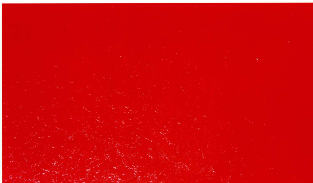
Пример отпечатков на поверхности покрытия от упаковки (слоя бумаги), образовавшихся при хранении изделия во влажных условиях.
