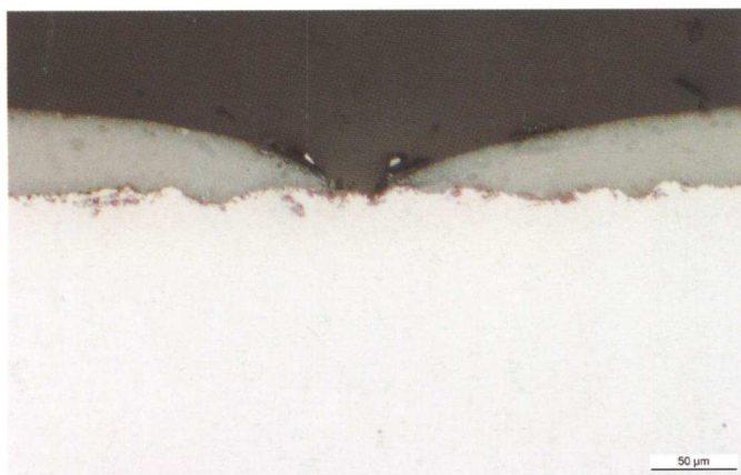
Плохое смачивание образца алюминия. Поверхность металла покрыта не удаленной до конца оксидной пленкой.
