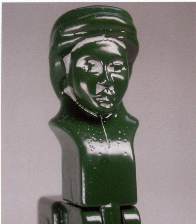
Пример эффекта обратной ионизации, который проявляется в образовании проколов (в основании фигуры) и эффекте «стягивания».
