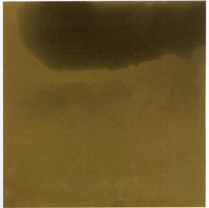
Пленка покрытия после штабелирования изделий без промежуточного слоя.
