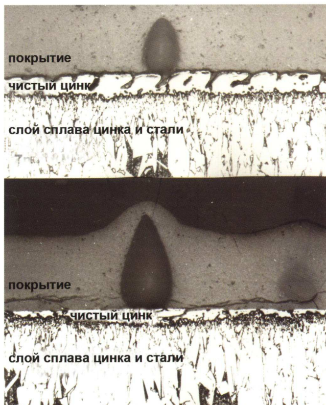
Поперечное сечение покрытия и цинкового слоя на участке образования дефекта.
