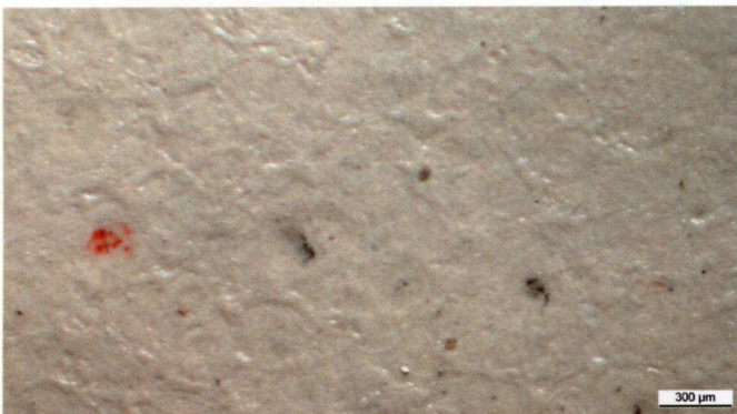
Загрязнение пигмента текстурированного покрытия тусклого цвета.
