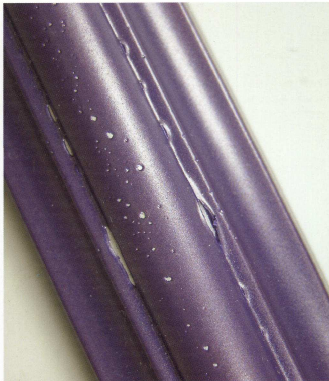
Пример «стягивания» покрытия на алюминиевом профиле.
