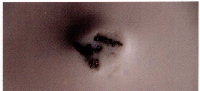
Металлические включения и стружка.
