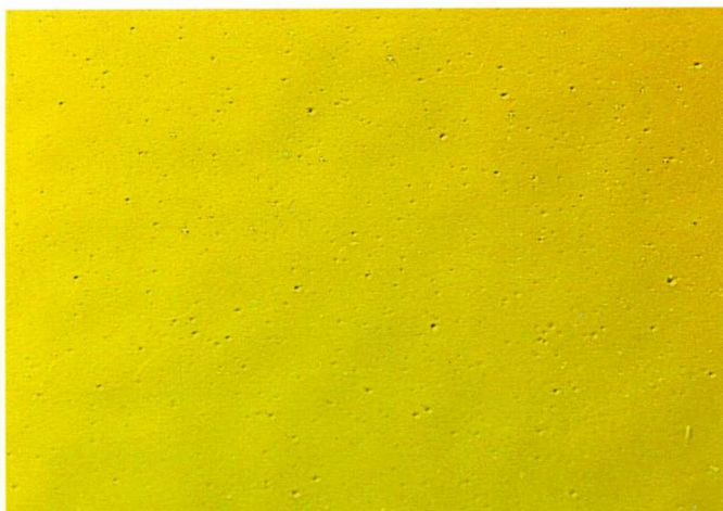
Проколы в полиэфирном порошковом покрытии, вызванные выделением летучих продуктов (слева: общий вид, справа: увеличение в 50 раз).
