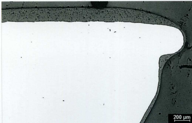
Пример распределения толщины порошкового покрытия на краевом участке.
