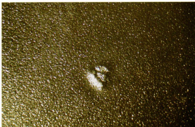
На фотографии поверхности показано вздутие в пленке текстурированного покрытия.
