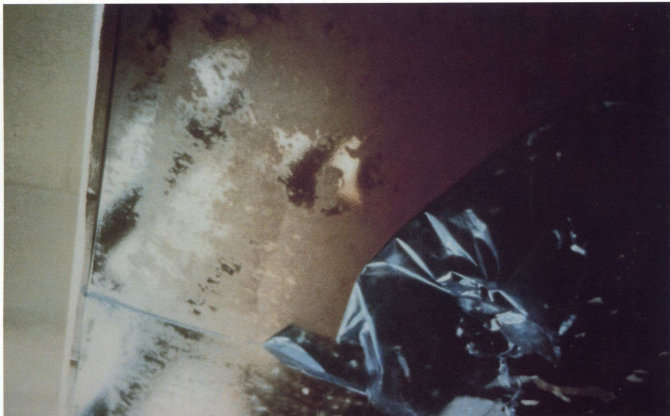
Изменения блеска и цвета пленки покрытия после удаления с изделия защитной фольги из ПВХ.
