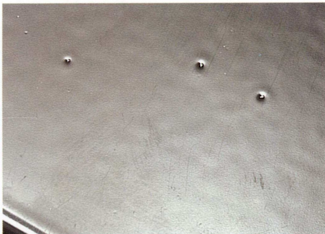
Порошковое покрытие с дефектами, пузырями, отпечатками в пленке.
