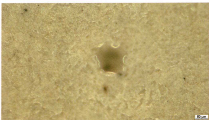
Дефектный участок на текстурированном покрытии. Критичной стала растекаемость (виден отпечаток).
