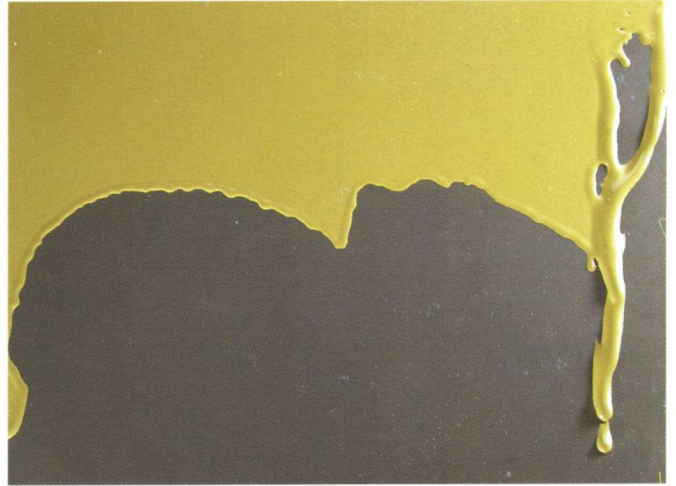
Обширный дефект смачивания на железо-фосфатированной стальной пластине.
