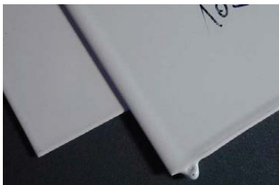
СПОЛЗАНИЕ ИЛИ СТЕКАНИЕ С ДЕТАЛИ ПОРОШКОВОЙ КРАСКИ, АХОДЯЩЕЙСЯ В ГЕЛЕОБРАЗНОМ СОСТОЯНИИ
